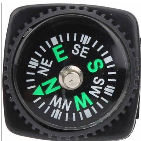
Foto 3, Brújula en el mástil para determinar el rumbo de los clic localizados.
