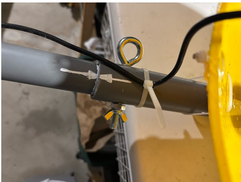
Foto 2, Detalle de la colocación del mástil que se puede quitar para su transporte.
